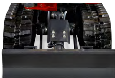
Sottocarro contratto, 680 mm : facilità di manovra
